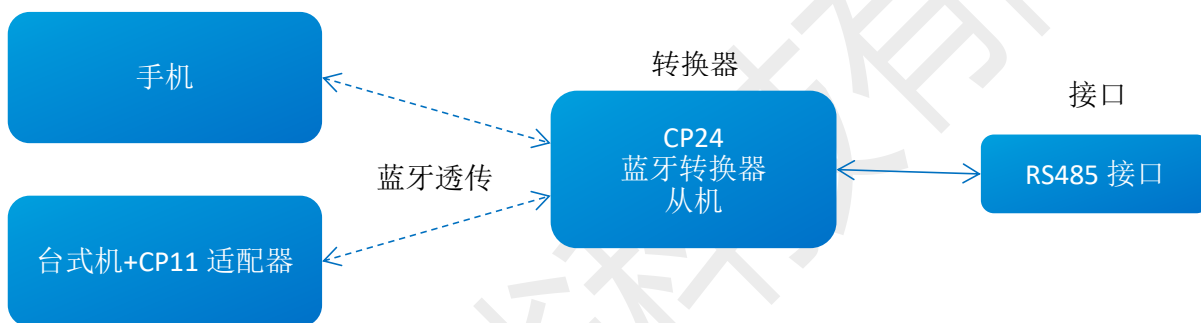
图 5：CP24 从机连接示意图
